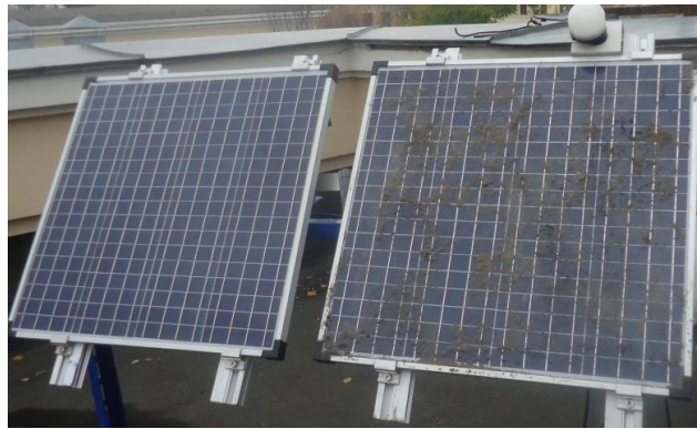
Рис. 10 – Солнечные модули в ходе эксперимента с «влажным запылением»: запыленный модуль справа Fig. 10 – Solar modules during the experiment with wet dusty module – on the right
