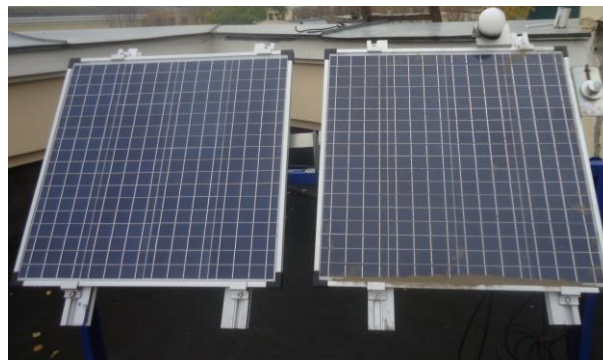
Рис. 9 – Солнечные модули в ходе эксперимента с «сухим запылением»: запыленный модуль справа; виден смонтированный на рамке модуля пиранометр для измерения солнечной радиации в плоскости солнечной батареи
