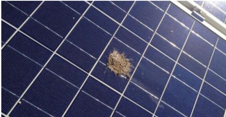
Рис. 1 – Локальное загрязнение ФЭП [6] Fig. 1 – Local contamination of the PV [6]
