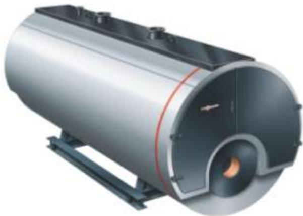
Специалист приводит в пример тепличный котел Vitomax LW типа MA4A. Этот водогрейный теплогенератор мощностью от 10,0 МВт до 14,0 МВт для температур подачи до 110 °С является совместной разработкой российских инженеров завода Viessmann в Липецке и немецких конструкторов. Теплообменные поверхности и дымогарные трубы в нем расположены таким образом, что это позволяет отказаться от дополнительных насосов котлового контура, за счет этого обеспечивается оптимизация средств на обустройство котельной.
