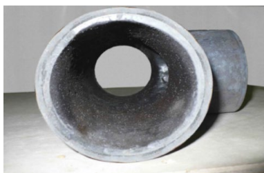
Рис.4. Вид тройника \varnothing 108 мм с нанесенным алюмотермическим покрытием
