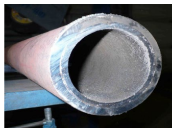
Рис.5. Трубы D=114 мм с нанесенным алюмотермическим покрытием.
