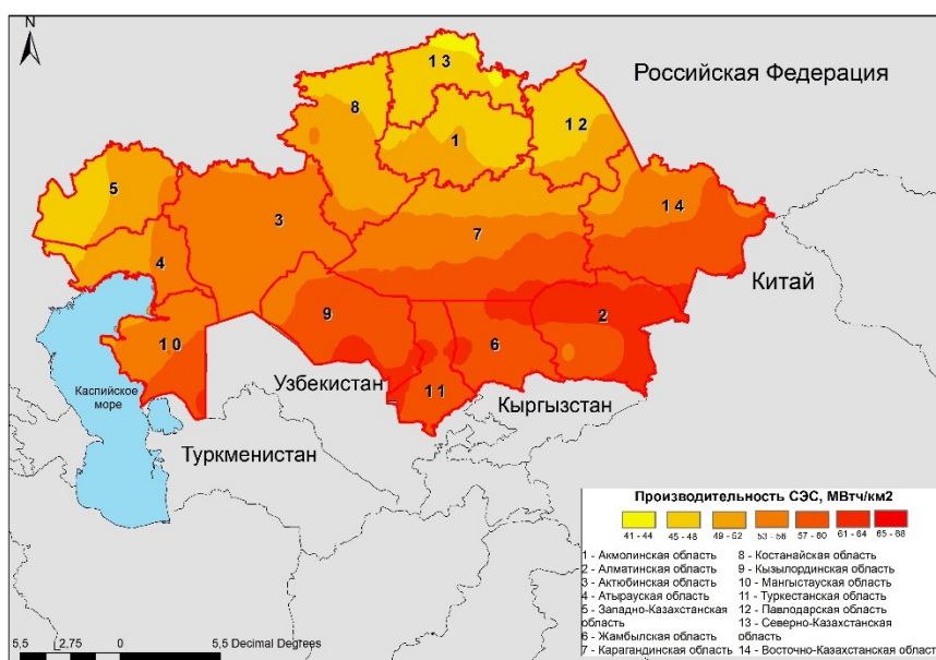
Рис.2. Удельная производительность СЭС, МВт*ч/км² за 2018 г. (составлено автором) Fig.2. Specific productivity of SPP (solar power plant), MWh / km² for 2018 (compiled by the author)
