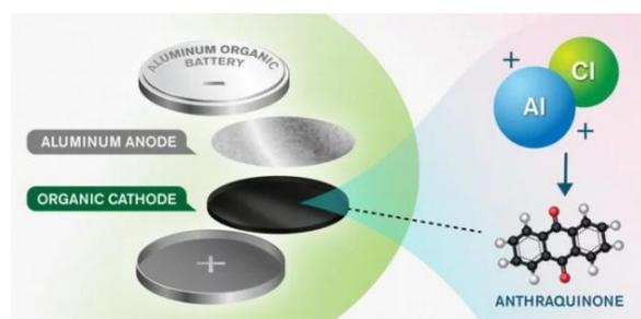
Схема устройства батареек нового типа
