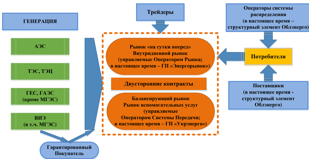
Рис. 5 – Структурная схема либерализованного рынка электроэнергии [19] Fig. 5 – The block diagram of liberalized electricity market [19]
