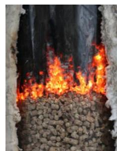
**Рис. 2** – Газификации пеллет в реакторе из кварцевого стекла
