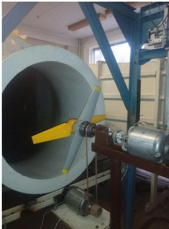
Рис. 1 – Экспериментальная установка в рабочей части аэродинамической трубы
