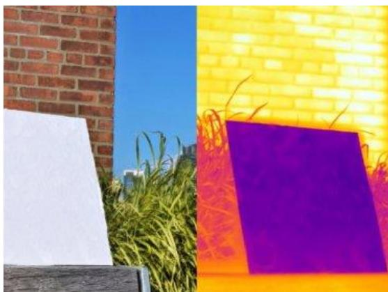
Как написал [sciencenews.org](http://sciencenews.org), полимерная краска, которая может охлаждать поверхности, наносится на различные материалы, включая пластмассы, металлы и древесину, может использоваться для покрытия домов, автомобилей или закрытых помещений.
