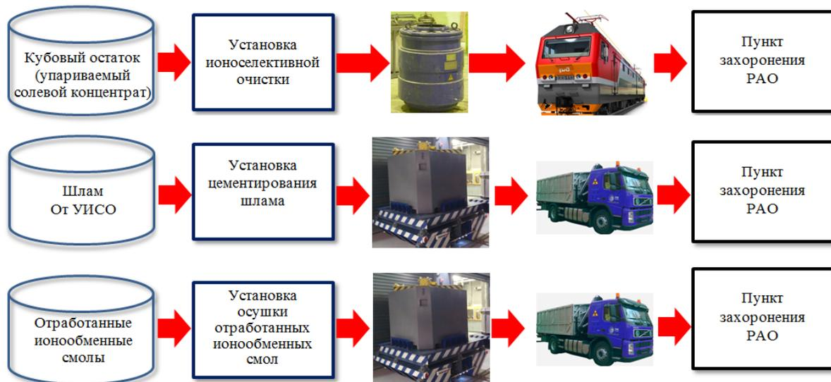
Рис. 1. Технологические линии по обращению с ЖРО на 1, 2, 3 блоках Белоярской АЭС
