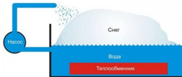
Рис. 5 – Принцип работы снегоплавильной установки [14]
