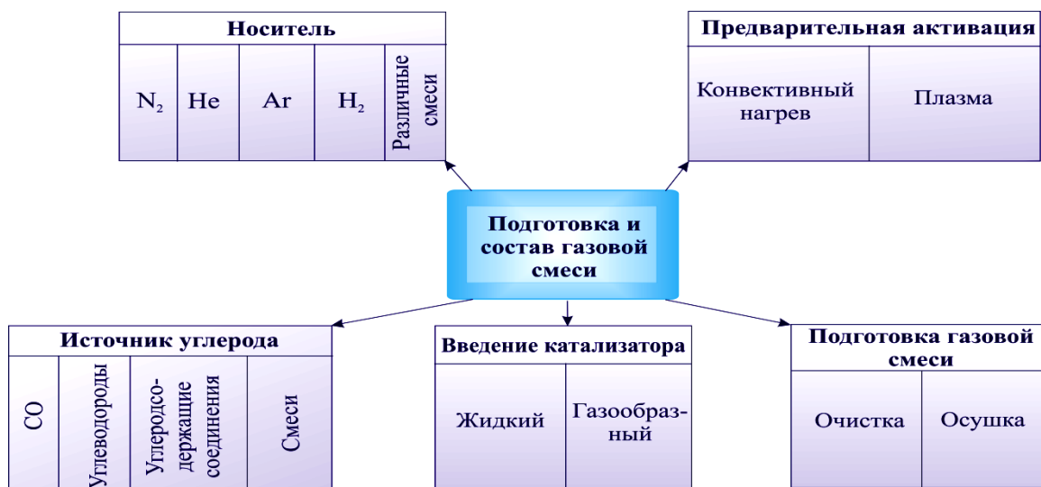
Рис. 2 – Приготовление и состав реакционной смеси Fig. 2 – Preparation and composition of the reaction mixture
