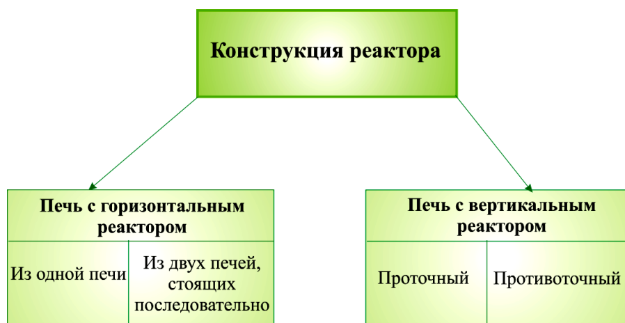
Рис. 4 – Конструкция реактора Fig. 4 – Reactor design
