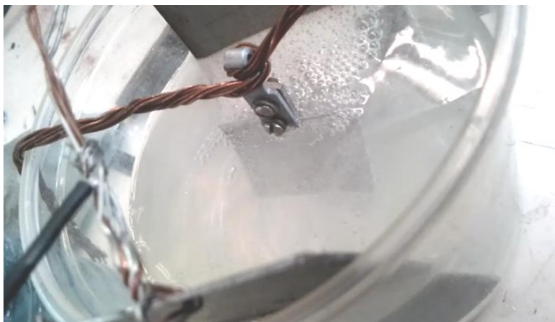
Рис. 5 – Образование газообразного кислорода на аноде при окислении алюминия
