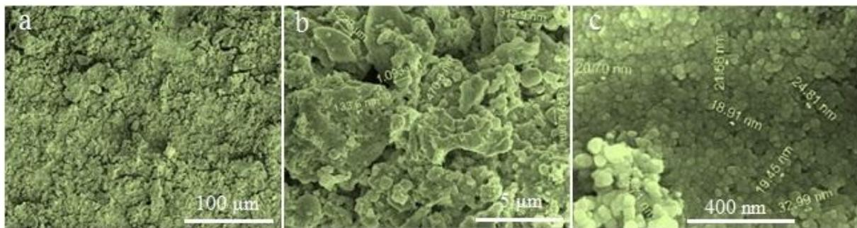
**Рис. 4** – Наноструктуры твёрдого осадка коллоида, полученного абляцией вольфрама в воде, масштаб: а – 100 мкм, б – 5 мкм, с – 400 нм
