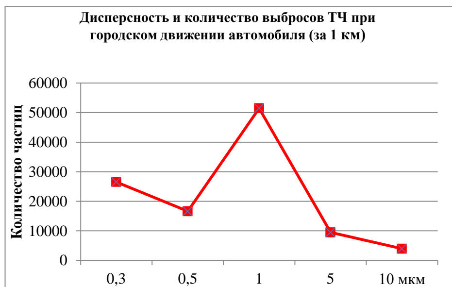
Рис. 6 – Дисперсность и количество выбросов ТЧ при движении автомобиля в городе Fig. 6 – Dispersibility and amount of PM emissions at urban vehicle driving
