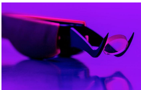
Оптическое стекло, созданное при помощи 3D-принтера Jason Laurea/LLNL
