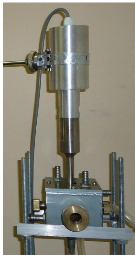
Рис. 1 – Установка для проведения экспериментов по синтезу водорода и анализу спектров свечения плазмы [11] Fig. 1 – Experimental setup for the synthesis of hydrogen and analysis of the plasma emission spectra [11]
