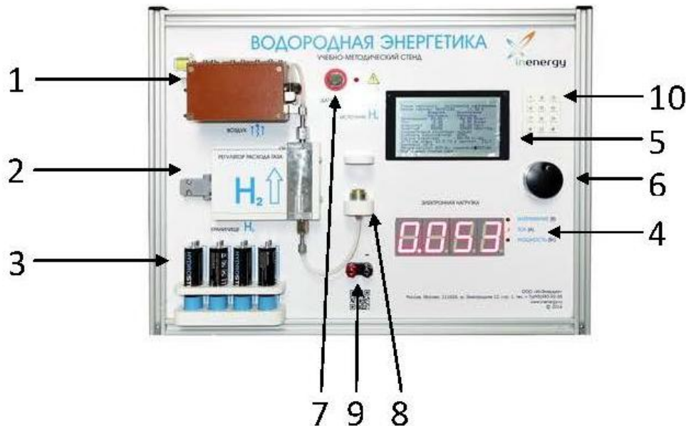
Рис. 1 – Стенд «Водородная энергетика»: 1 – 30-ваттный стек; 2 – измеритель расхода водорода; 3 – металлгидридные баллоны; 4 – плата управления (располагается за панелью стенда); 5 – дисплей, 6 – квадратурный энкодер (манипулятор); 7 – датчик водорода; 8 – посадочное место металлгидридного баллона; 9 – разъем подключения внешней нагрузки; 10 – клавиатура ввода параметров
