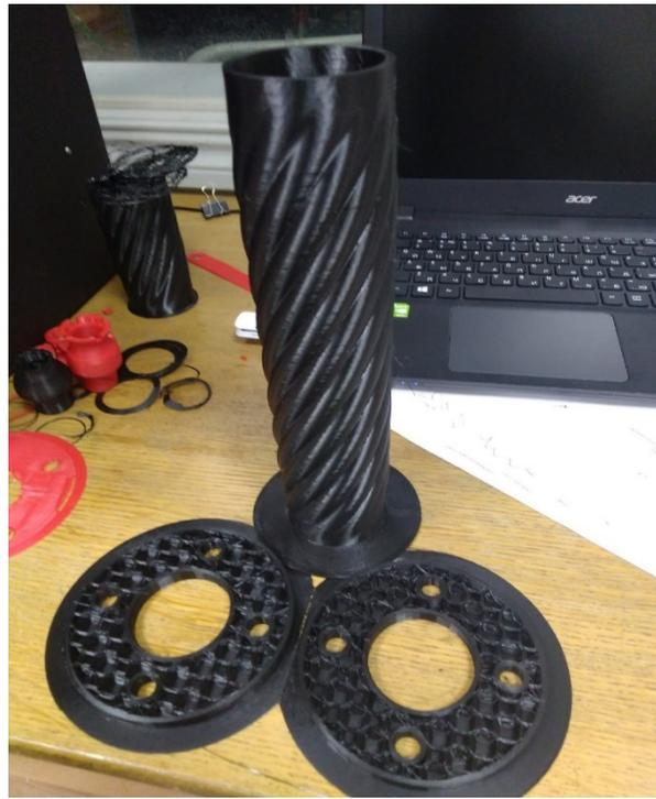
Рис. 6. Напечатанная на 3d-принтере вставка с лежащими рядом фланцами.
