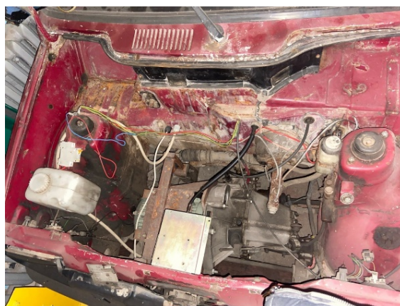
Рис. 2. Моторно-трансмиссионное отделение электромашины «Ока-Э».
