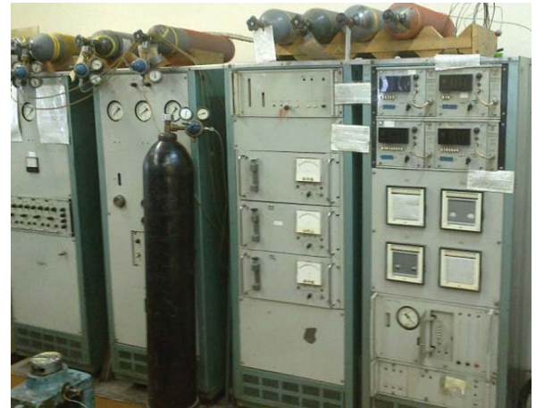
Рис. 3. Общий вид оборудования газового анализа АСГА-Т
