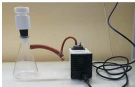
**Рис. 5. Экспериментальная фильтровальная установка**
