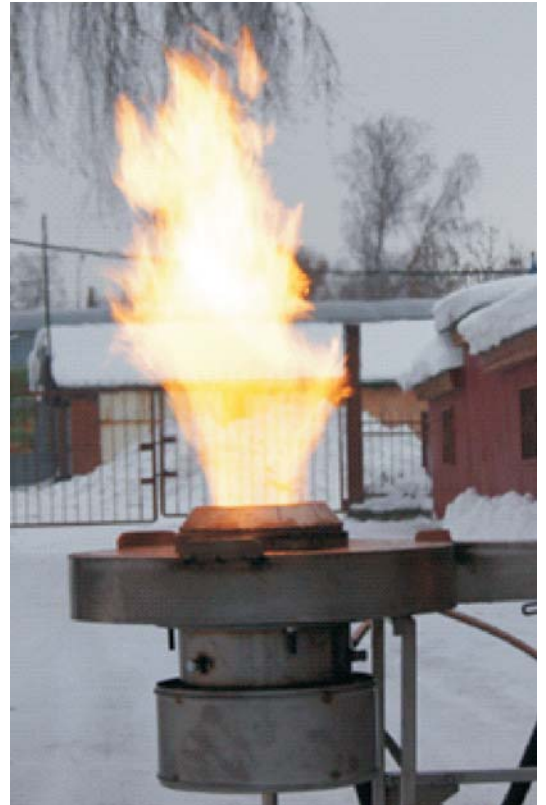
Рис. 1. Общий вид безфорсуночного горелочного устройства ВГУ-1
