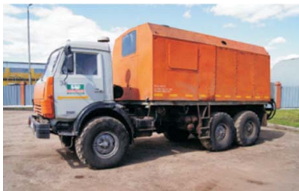
Рис. 4. Общий вид ППУ 1600/100 с безфорсуночным горелочным устройством ВГУ-1
