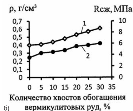
Рис. 2. Зависимость плотности (1) и прочности (2) пеносиликатов от количества диопсида (а) и количества хвостов обогащения вермикулитовых руд (б)
