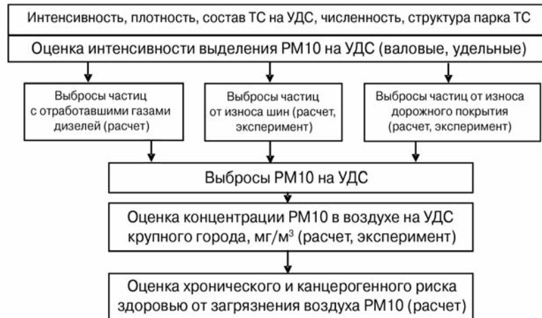
Рис. 1. Блок-схема методики оценки риска от загрязнения воздуха взвешенными частицами (PM10) на УДС крупного города
