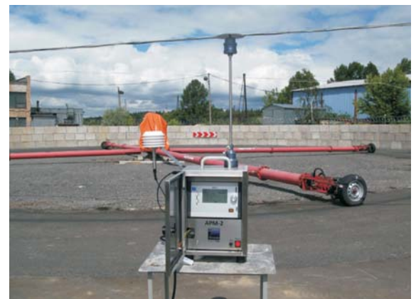
Рис. 2. Спектрофотометр АРМ-2 на легковом стенде "Карусель"
