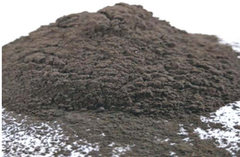
Рис. 2. Общий вид золошлаковых отходов после их обработки (помола) в лабораторных условиях
