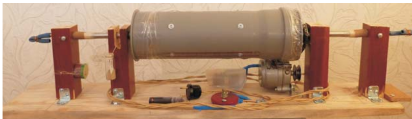
Установка для исследования адсорбции вредных веществ из дымовых газов
