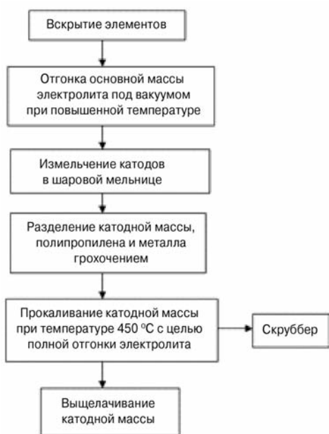
Рис. 3. Схема утилизации элементов электрохимической системы \text{Li-Mn} переработки катодной массы Fig. 3. Scheme of utilization of the elements of the \text{Li-Mn} electrochemical system of cathode mass processing
