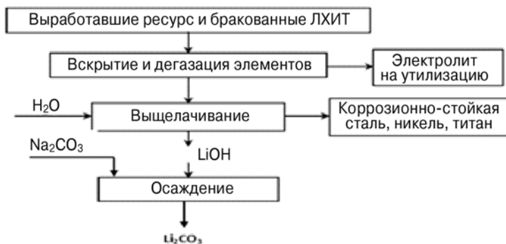
Рис. 2. Технологическая схема утилизации ЛИИТ Fig. 2. Technological scheme of disposal of LICS
