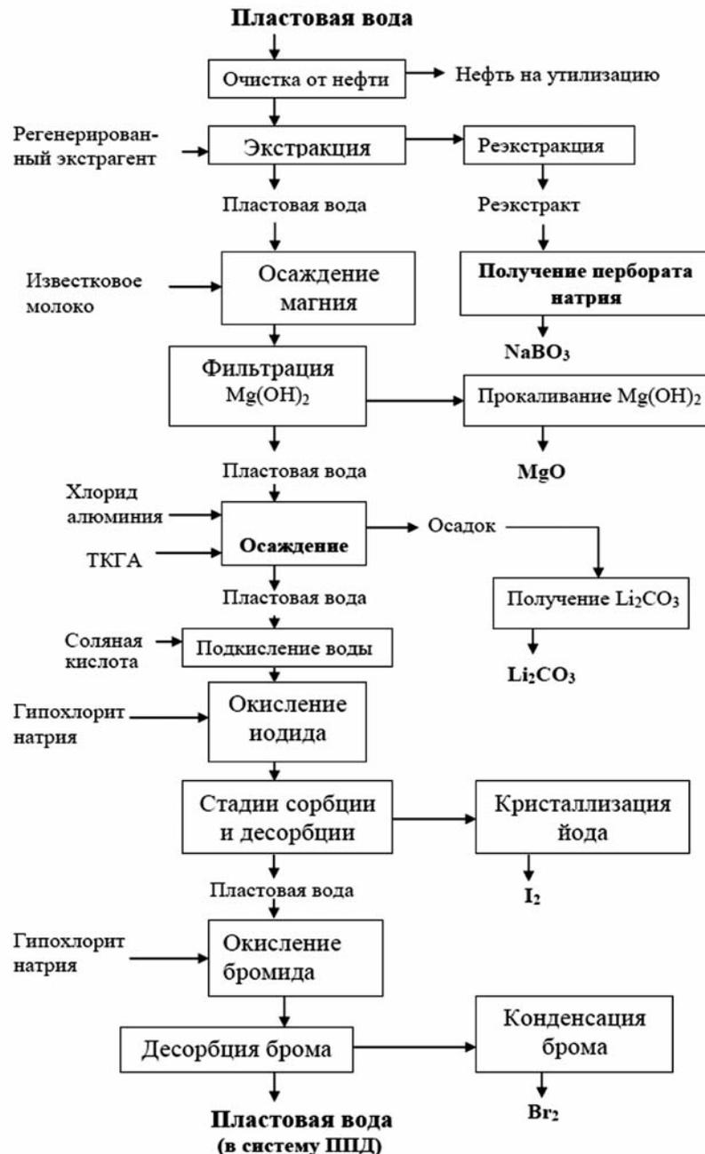
**Рис. 1. Комплексная технологическая схема переработки и очистки пластовых вод месторождений углеводородов**
