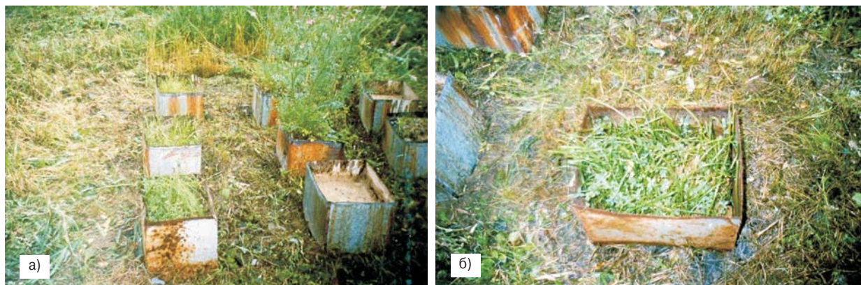
Рис. 3. Закрепление пылящих поверхностей в кюветках с хвостами химическое (а) и обработанными окатышами (гранулами) на основе грунтосмесей и специально подготовленным составом (б). Общий вид Fig. 3. Fixing of dusting surfaces in cuvettes with chemical tailings (a) and treated pellets (granules) on the basis of soil mixtures and specially prepared composition (b). General form
