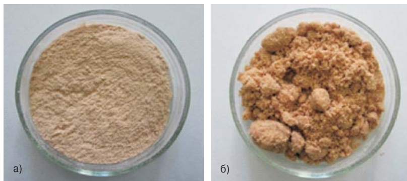
Рис. 1. Микроцеллюлоза "чистая" (а) и отработанная (б)
