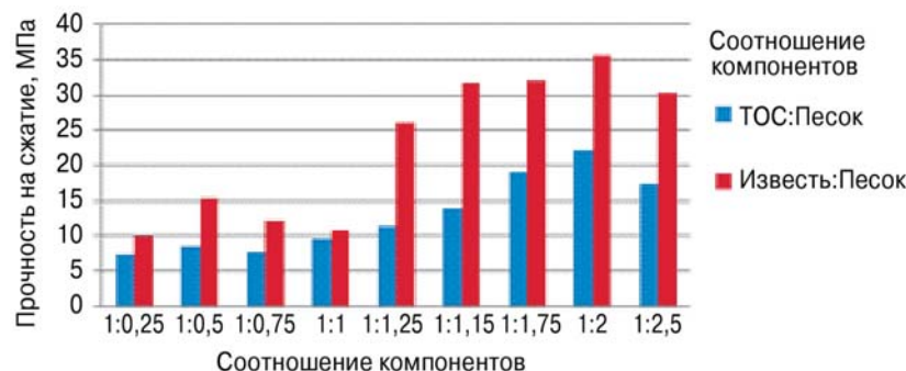
Рис. 2. Прочность силикатных образцов, изготовленных с использованием известково-кремнеземистого вяжущего с различным соотношением компонентов
