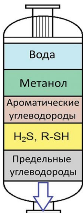
Рис. 4. Схематическое распределение компонентов ГПП в адсорбционной колонне
