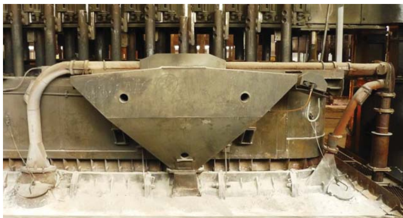
Рис. 1. Экологичный электролизер Содерберга, оборудованный четырехкупольной системой газоудаления
