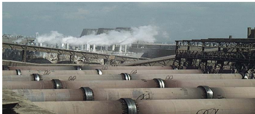
Рис. 1. Вращающиеся печи спекания Fig. 1. Rotary sintering furnaces
