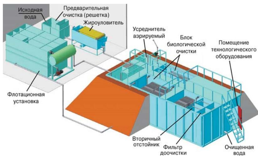
**Рис. 2. Технологическая схема очистки сточных вод предприятий пищевой промышленности**
