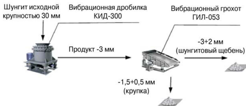
Рис. 3. Схема подготовки минеральной кормовой добавки на основе шунгита
