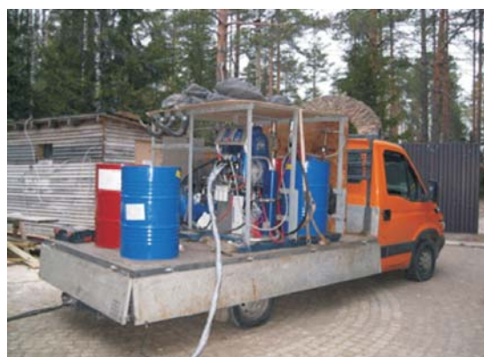
Рис. 5. Мобильная установка для производства сорбента
