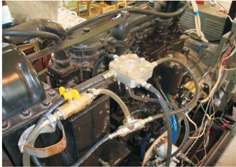
Рис. 2. Система подачи газомоторного топлива с внутренним смешиванием
