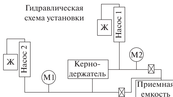
Рис. 2. Принципиальная гидравлическая схема и внешний вид установки ПУМА-650 (ЭКОПЛАСТ).
