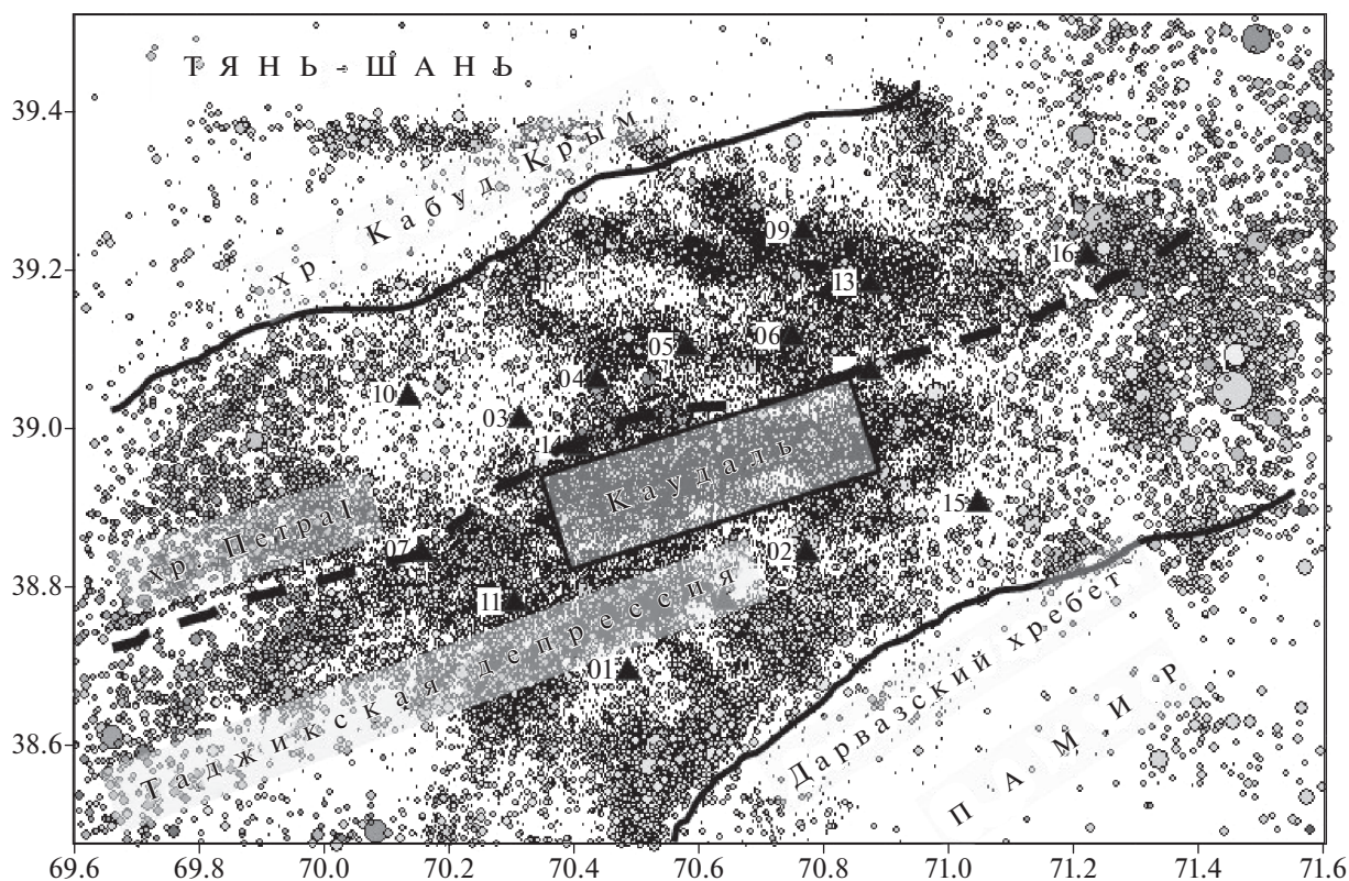
Рис. 1. Элементы тектоники и система сейсмологических наблюдений на Гармском полигоне КСЭ ИФЗ АН СССР. Треугольники с номерами – сейсмические станции. Мелкие кружки – эпицентры землетрясений с M \geq 0.5 , произошедших в период с 01.01.1955 по 31.03.1992 гг. Прямоугольный квадрат в центре – локальный район (ЛР) Каудаль, используемый для исследования временных вариаций b -value с глубиной.
