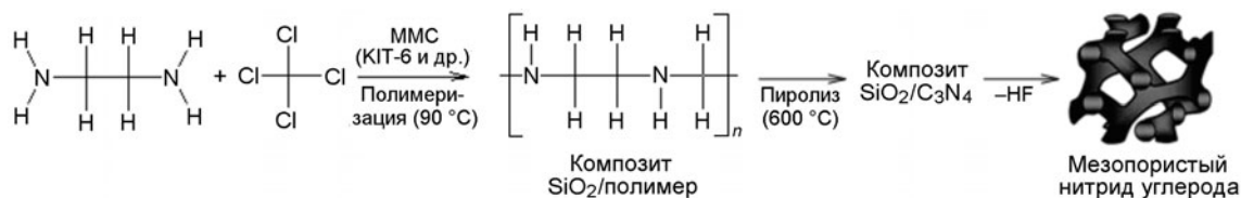
Рис. 3. Схема получения мезопористого нитрида углерода из этилендиамина и четыреххлористого углерода.
