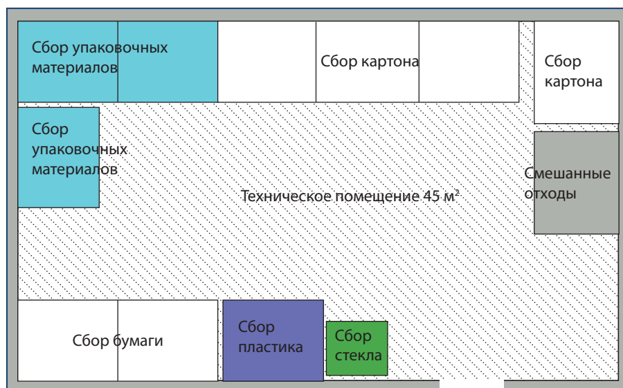
Рис. 2. Пример оборудования одного из помещений торгового центра для раздельного сбора отходов, кроме пищевых фракций (для них выделены отдельные помещения). Все контейнеры – объемом 1100 л, контейнер для сбора стекла – 240 л
