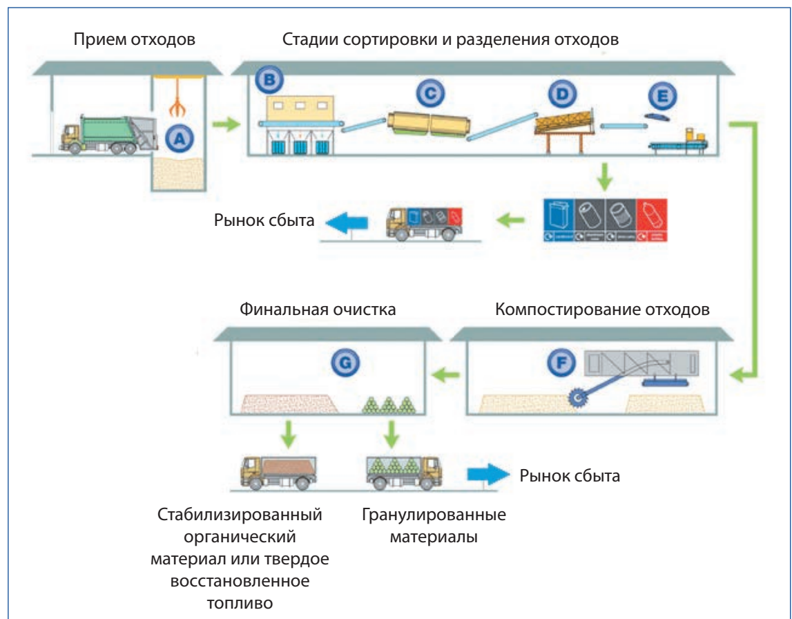
Рис. 1. Схема предприятия по переработке отходов во вторичное сырье и топливо.
