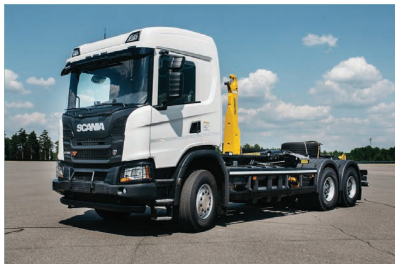
Рис. 2. Крюковой погрузчик G410B6x4NA производства Scania
