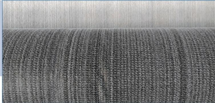
**Б**ентонитовый мат **Isobent** представляет собой гидроизоляционную мембрану для подземной гидроизоляции. Материал использует свойство бентонита образовывать водонепроницаемый слой, увеличивая многократно свой объем при контакте с водой. **Isobent** производится как трехслойный сэндвич – гранулированный бентонит помещается между двумя слоями геотекстиля.
