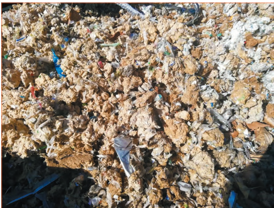
Рис. 2. Загрязненная фракция, получаемая при неналаженном процессе переработки
