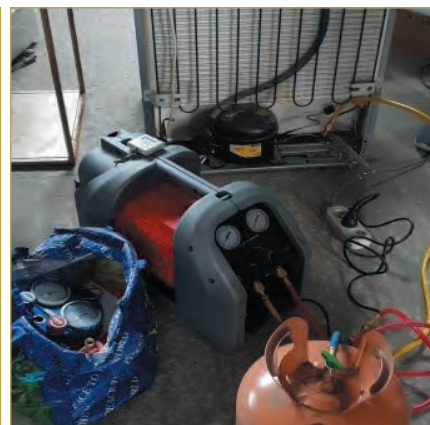
Фото 3. Удаление фреона из отработанного холодильника (ТОО «Technic Destroy»)
