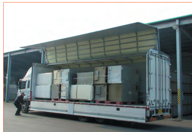
Фото 1. Транспортирование крупногабаритных ОЭЭО
