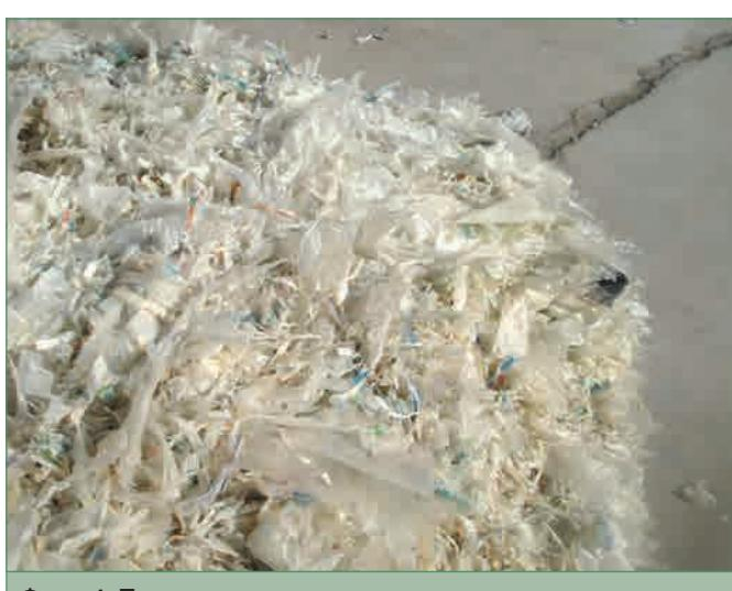
Фото 4. Полиэтилен после отделения от алюминия
