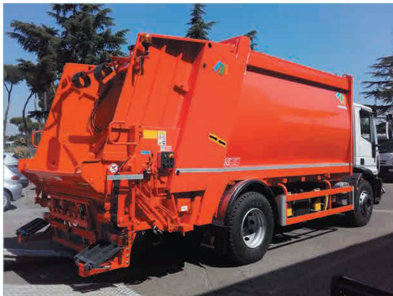
Фото 1. Мусоровоз Mazzocchia MAC3B с объемом бункера 12–18 м 3
